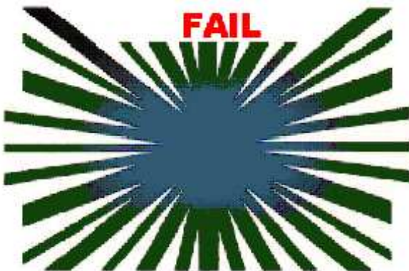
Fig.9 : Test Bowie Dick non conforme
